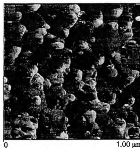
Рис. 2. Двовимірна топологія поверхні ZnO на підкладці GaSe.
